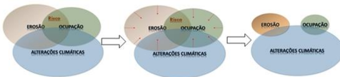
Figura 8.20 Redução do risco por meio de ações de proteção (controle da erosão) e de realocização (diminuição da ocupação em troços de risco crítico).
